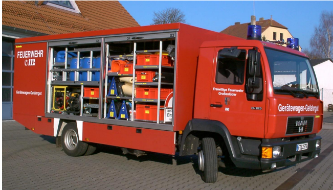
Ansicht 18: Gerätewagen-Gefahrgut GW-G (7,5 t) der Freiwilligen Feuerwehr Großnieder. Besatzung 2 Mann. Anschaffungskosten nach der Brandschutzförderrichtlinie 194.000 €.
