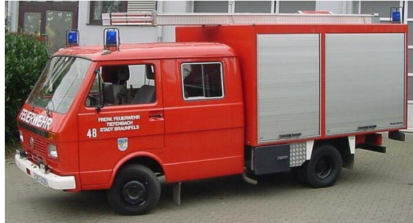
Ansicht 16: Tragkraftspritzenfahrzeug mit vierteiliger Steckleiter der Freiwilligen Feuerwehr Tiefenbach in Braunfels. Besatzung 6 Mann. Anschaffungskosten nach der Brandschutzförderrichtlinie 84.000 €.
