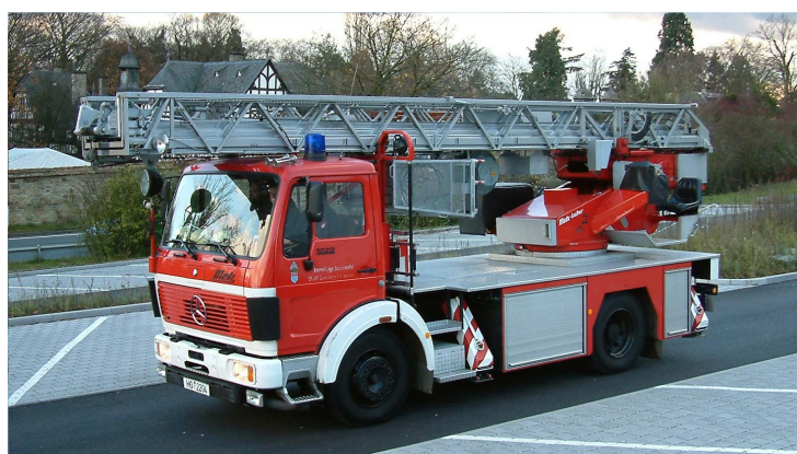
Ansicht 20: Drehleiter (DLK 18/12) der Freiwilligen Feuerwehr Kronberg im Taunus. Besatzung 2 Mann. Anschaffungskosten nach der Brandschutzförderrichtlinie 332.000 €.
