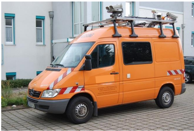
Ansicht 197: Fahrzeug zur Erfassung der Straßenzustände in den geprüften Kommunen.
