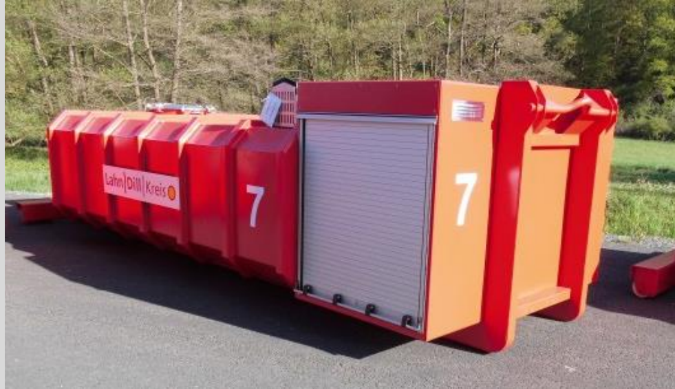
Ansicht 111: Lahn-Dill-Kreis. Mobiler Löschwasserbehälter 10.000 m³, abrollbar. Aufnahme vom Lahn-Dill-Kreis.
