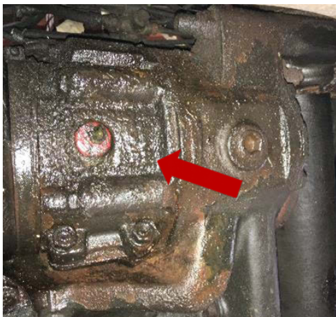
Ansicht 110: Bauhof Eppstein, Undichtigkeit am Unimog U900. Aufnahme vom 26. Juli 2016.
