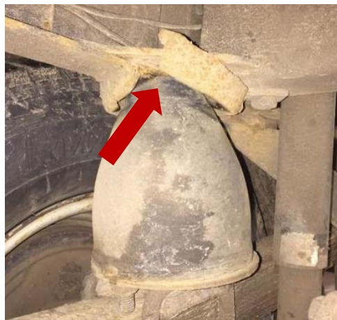
Ansicht 111: Bauhof Lahntal-Wetter-Cölbe, gebrochener Aufnahmeteller Hubsteiger. Aufnahme vom 15. Februar 2016. 166
