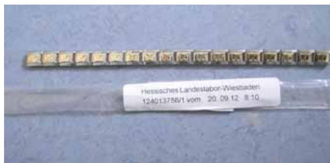
Abbildung 1.36: Überhöhte Nickelabgabe bei einem Armband
