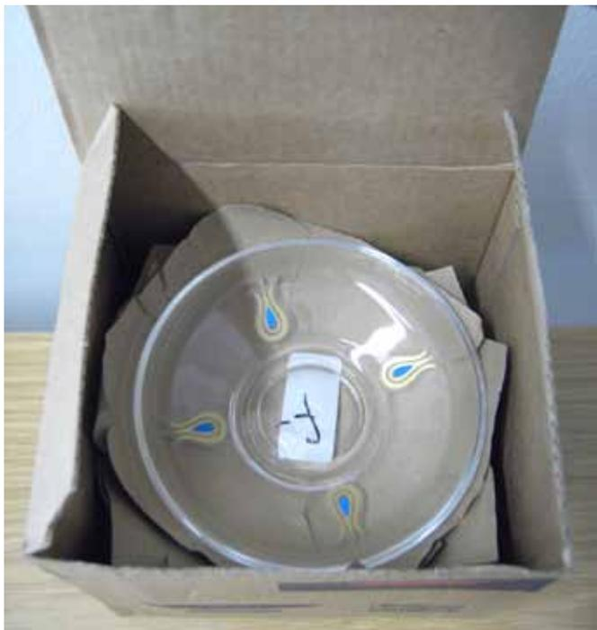
Abbildung 1.43: Erhöhte Bleiabgabe aus dem Dekor eines Teeglasuntersetzers
