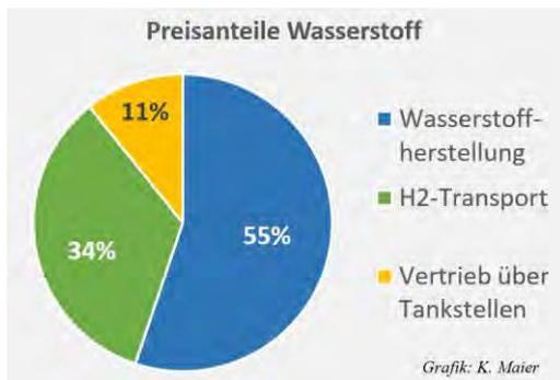
Mehr als die Hälfte des Tankstellenpreises resultiert aus der Wasserstoffherstellung, aber auch der Transport nach und in Deutschland erzeugt ein Drittel der Kosten.
