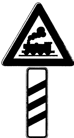
dreistreifige Bake (rechts) vor unbeschränktem Bahnübergang
