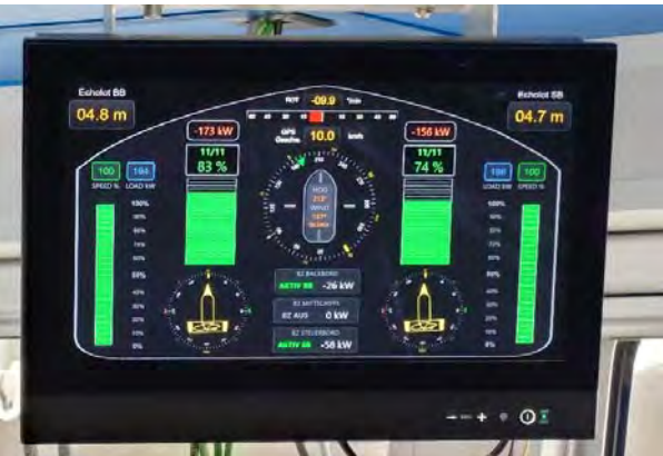
Antriebsleistung, Geschwindigkeit, Akkumulatoren
