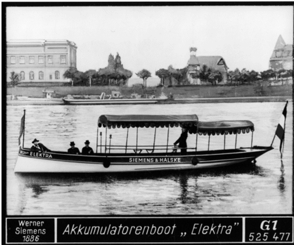
Auf der Spree in Berlin erprobte Siemens im Jahr 1886 sein erstes Elektroboot. Die „ELECTRA“ konnte 25 Passagiere aufnehmen und war 14 km/h schnell.
